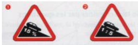
15 % : Pour un déplacement de 100 m à l'horizontale le dénivelé est de 15 m
